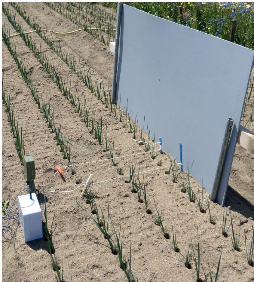
> DISPOSITIF DE PRISE DE VUE POUR L'ACQUISITION DES DONNÉES À L'AIDE DE LA CAMÉRA BEECAM
